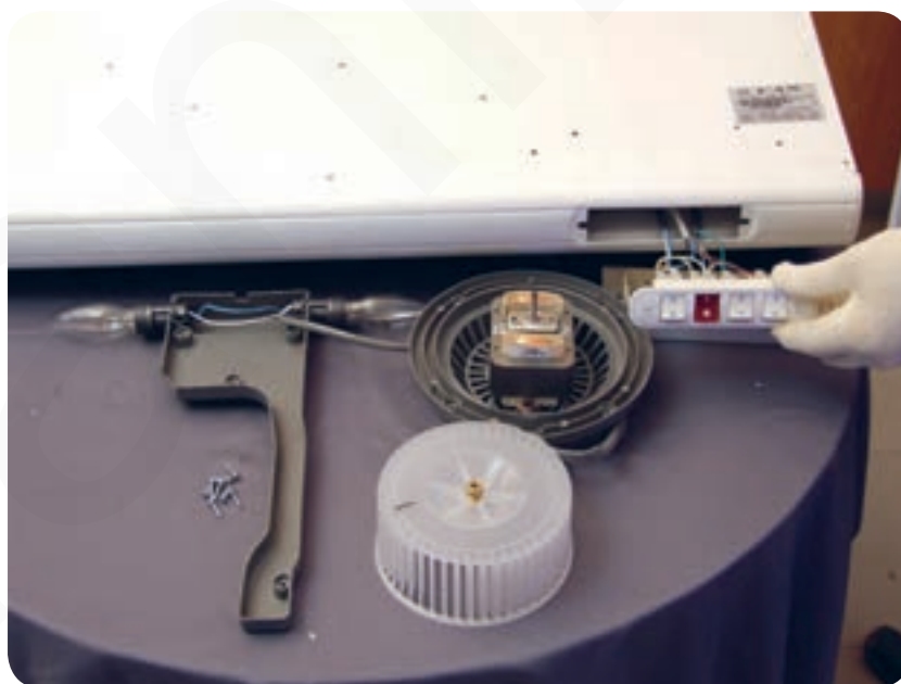
شکل ۱-۲۴ نقشه انفجاری هود آشپزخانه (دید از بغل)
