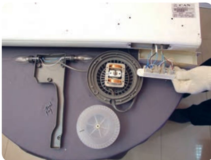
شکل ۱-۲۳ نقشه انفجاری هود آشپزخانه (دید از بالا)
