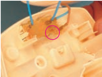
الف - پلاتین‌ها در حالت قطع
